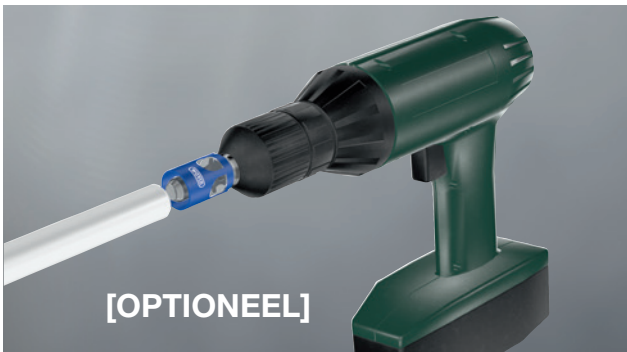
Fig.11: Kalibreren reduceert de insteekkracht.
