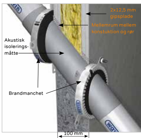
Vinklet gennemføring < 45° med eller uden muffe.
