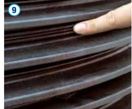
Falls nötig, kann das Schachtrohr mit integriertem Steiggang entsprechend der Einbautiefe an markierten Stellen im Abstand von 125 mm abgelängt werden. Hierzu ist das Rohr mit Hilfe einer Säge zwischen zwei kleineren Doppelrippen zu durchtrennen und zu entgraten.
