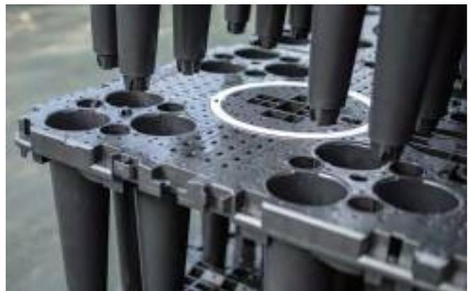
Anschließend kann das Element ohne Bodenplatte direkt auf die Oberseite des darunterliegenden Elements gesetzt werden. Jede der Säulen kann in die dafür vorgesehenen Öffnungen eingesetzt und eingerastet werden.
