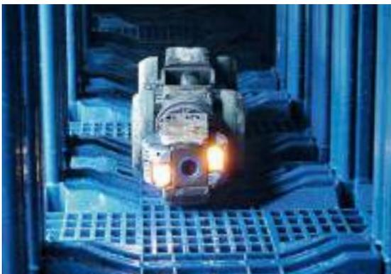
Nach einer mehrjährigen Funktion der Rigole kann das System über die Kontrollschächte inspiziert werden. Eine Kamerabefahrung gibt dabei genauere Informationen über den Verschmutzungsgrad der Rigole.
