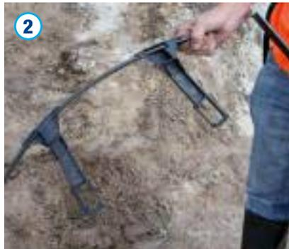
Hierbei ist darauf zu achten, dass die Öffnungen der Aufnahmevorrichtung nach innen zeigen und sich an die Ringform des Spannringes parallel anlegen.
