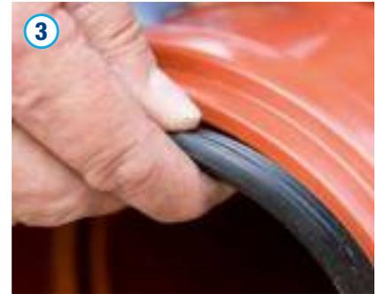
Die Dichtung kann bei Bedarf zum Beispiel zu Inspektions- und Reinigungszwecken herausgenommen werden und nach erfolgter Reinigung mühelos wieder eingesetzt werden.
