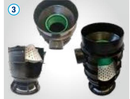
Der Schlammfang wird mit Grobfilter und Einlaufstutzen (grün) geliefert. Bei der Installation ist darauf zu achten, dass beide Komponenten richtig eingesetzt sind und nicht verunreinigt oder beschädigt werden.
