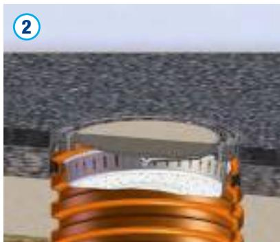
Die Abdeckung ist auf das vorbereitete Auflager zu legen. Bei Einsatz eines Dichtringes (Art.-Nr. 4023826) ist dieser im ersten Wellental außen einzulegen und mit Gleitmittel zu versehen. Eine direkte Auflage auf den Konushals ist durch eine Setzungsfuge von ca. 10 mm zu vermeiden.
