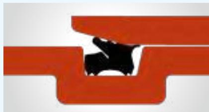
Durch den vierstufigen Aufbau werden die Steckkräfte deutlich minimiert und das Herstellen der Verbindung vereinfacht.
