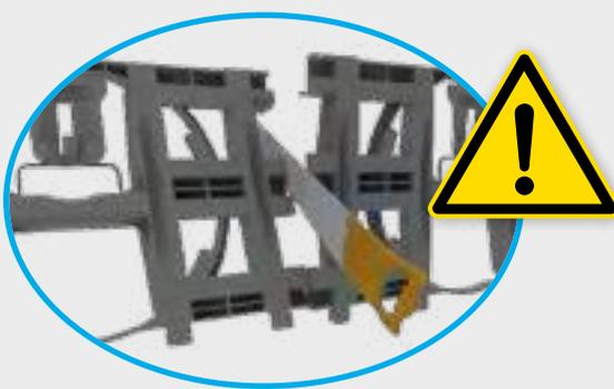
**Hinweis:** Sollten die Abmessungen des Gesamtsystem es erfordern, dass eine Seitenplatte in der Mitte getrennt werden muss, achten Sie bei der Verlegung darauf, dass die abgerundete, äußere Kante (nicht die Schnittkante!) der halben Seitenplatte in Richtung der äußeren Ecke der Rigole verlegt wird
