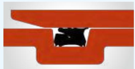
Die Stützlippe legt sich bei vollständig eingeschobenem Rohr zusätzlich gegen die Rohrwand. Somit dichten vier Dichtlippen das Rohr ab, um sowohl bei Innen- als auch Außendruck eine hohe Dichtsicherheit zu erzielen.
