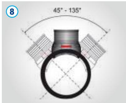
Das Anbohren des X-Stream Rohres ist mit einem geeigneten Kronenbohrer ( $\text{Ø } 177 \text{ mm} \pm 0,5 \text{ mm}$ ) inklusive Zentrierbohrer (s. Lieferprogramm) durchzuführen. Die Bohrung ist senkrecht zur Rohrachse, mittig zwischen 2 Wellen im Wellental auszuführen.
