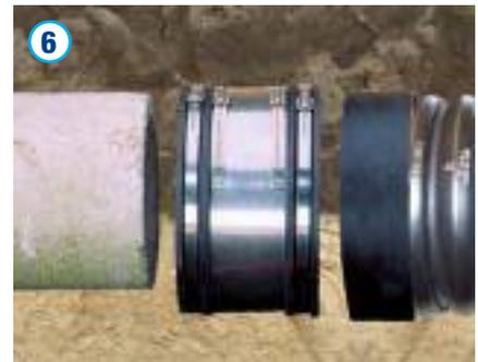
Für den Übergang auf alternative Rohrleitungen sind Übergangskupplungen zu verwenden. Bei Beton- und Steinzeugrohren ist die Außendurchmesserabweichung mit Ausgleichsringen zu kompensieren. Für Gussrohre ist die X-Stream Dichtung zu verwenden. Zum Verbinden von unterschiedlichen Rohrenden mittels Kupplungen bitte Herstellerhinweise beachten.
