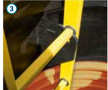
Für die Arretierung der Steigleiter wird die Leiter in der Steigleiteraufnahme im Konus eingerastet. Hierzu ist die Leiter über die Aufhängung zu führen, so dass sich diese an den Innenseiten der Steigleiter befindet. Dann ist die Leiter in die Aufnahme zu drücken, bis sie beidseitig fest einrastet.
