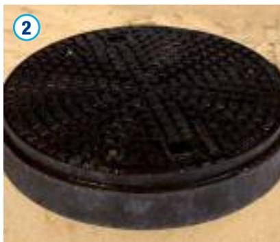
Die Abdeckung ist unmittelbar auf den Konus aufzulegen. Ein Beton- oder Kunststoffauflagering ist hierfür nicht erforderlich. Der Schacht ist bis zur Abdeckung gemäß DIN EN 1610 zu verfüllen und zu verdichten. Die Oberfläche kann abschließend gemäß den Planungsvorgaben erstellt werden.
