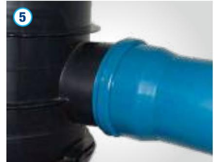
Das Spitzende des Straßenablaufs ist mit dem vorgesehenen Rohrsystem zu verbinden. Hierbei wird die Muffe des Rohrsystems auf das Spitzende DN/OD 160 geschoben. Die Verlegeanleitungen des Rohrherstellers sind zu berücksichtigen.
