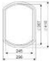
**Ersatzdichtung** › für Auflagering 300x500
