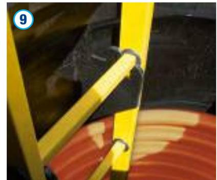
Für die Arretierung der Steigleiter wird die Leiter in der Steigleiteraufnahme im Konus eingerastet. Hierzu ist die Steigleiter in die Aufnahme zu drücken, bis sie beidseitig fest einrastet.
