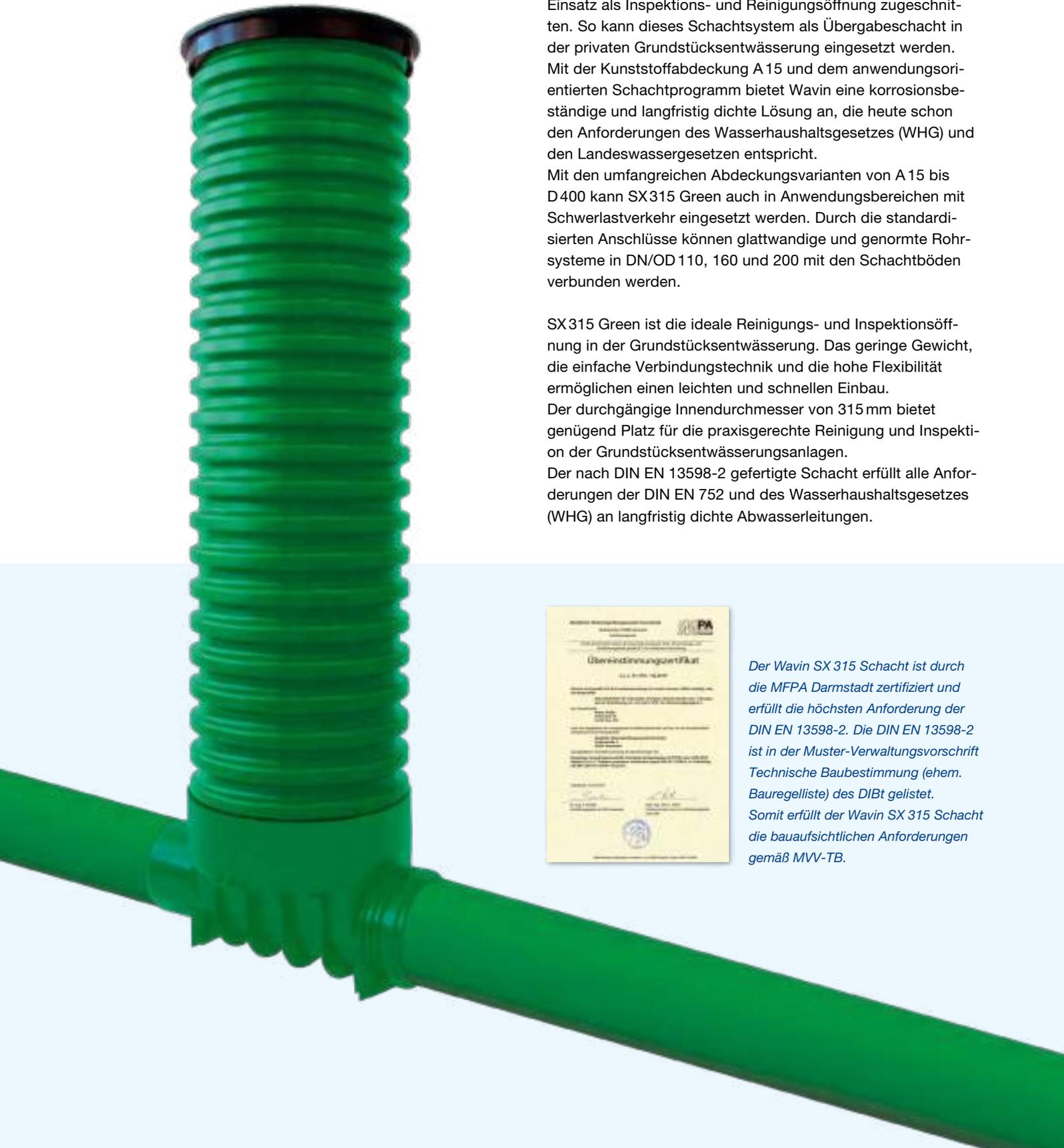
Wavin SX315 Green ist in seiner Konstruktion genau auf den Einsatz als Inspektions- und Reinigungsöffnung zugeschnitten. So kann dieses Schachtsystem als Übergabeschacht in der privaten Grundstücksentwässerung eingesetzt werden. Mit der Kunststoffabdeckung A 15 und dem anwendungsorientierten Schachtprogramm bietet Wavin eine korrosionsbeständige und langfristig dichte Lösung an, die heute schon den Anforderungen des Wasserhaushaltsgesetzes (WHG) und den Landeswassergesetzen entspricht.
