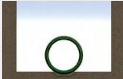
**Typ 2: Auflager auf einer vorbereiteten und vorgeformten Grabensohle**
