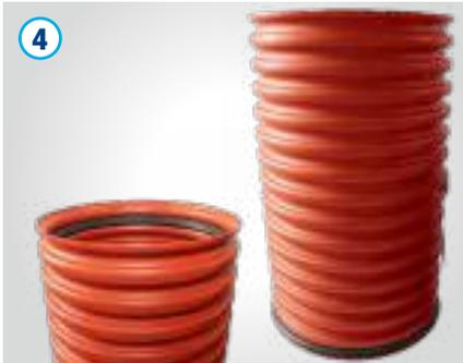
Beim Tegra Straßenablauf mit Schlammfang ist grundsätzlich ein Wellrohr als Verbindung zwischen Schlammfang und Aufsatz einzusetzen. Das Wellrohr ist gegebenenfalls entsprechend der Einbautiefe zu kürzen. Zuerst ist das 750 mm Wellrohr mit geeignetem Werkzeug auf die richtige Länge zuzuschneiden und zu entgraten.
