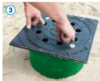
Das Auflager für die Teleskopabdeckung ist entsprechend der Belastungsklasse (SLW 30/SLW 60) aus einer 250 mm breiten und min. 150 mm hohen Ortbetonschicht herzustellen und gleichmäßig um das Schachtröhre/Teleskoprohr auszuführen. Je nach Belastungsklasse kann ggf. ein größeres Auflager erforderlich werden. Die Abdeckung ist ohne Punktlasten und Hohlräume in das Auflager einzubetten.
