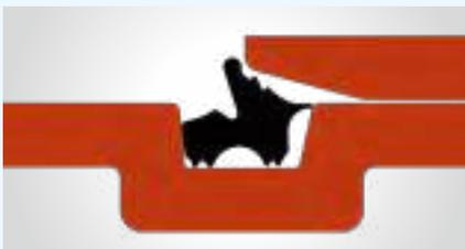
Durch die spezielle Konstruktion wird der Dichtring fest in der Sicke positioniert. Hierbei wirkt die erste Lippe als Stützlippe.
