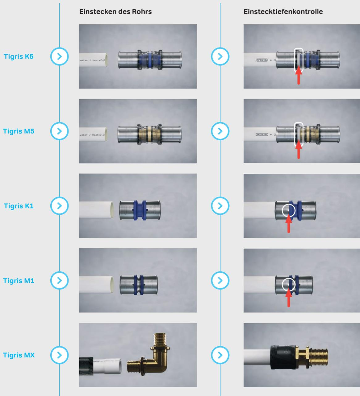
Prüfung der korrekten Einführung des Rohrs mit Einstecktiefenkontrolle
