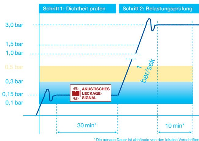
Protokoll Druckprüfung bei Prüfung mit Luft
