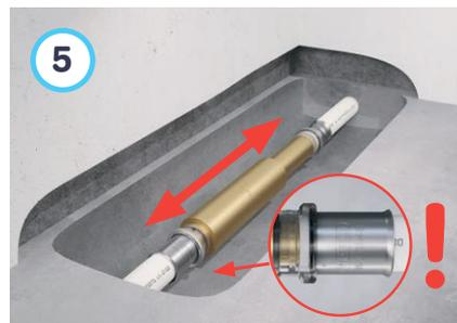
5 Freies Ende der Reparaturkupplung herausziehen und das andere Verbindungsstück auf das verbleibende freie Rohrende stecken. Im Sichtfenster korrektes Einschieben des Rohrs prüfen.
