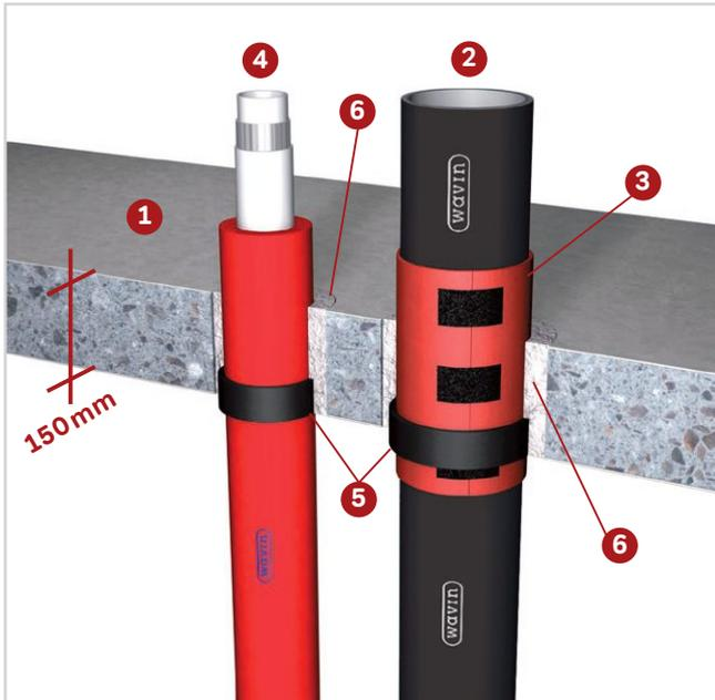
Gerade Rohrführung durch Decke
