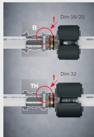
Die Pressbacken dürfen **nur die Metallhülse** bedecken, zwischen dem Hülsenkragen und dem transparenten Fixringkragen. Fixring als Führung verwenden.
