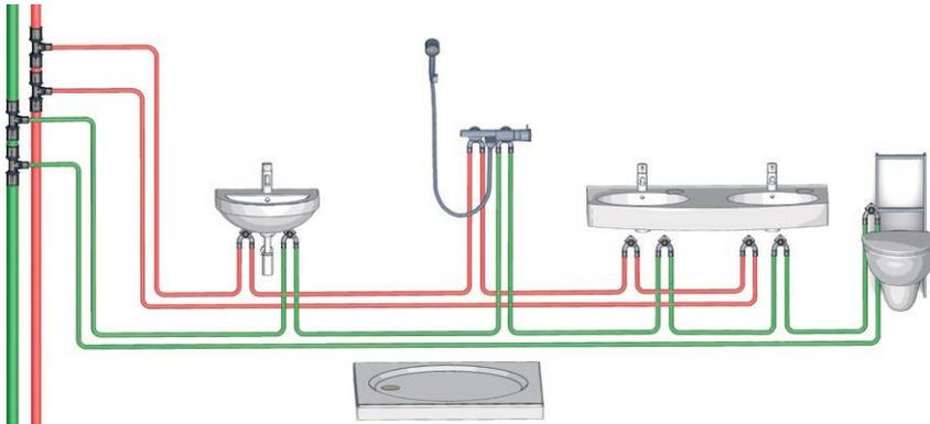
Die hier dargestellte Schleifen-/Ringleitungsinstallation eignet sich für Stockwerksinstallationen mit vorgeschalteten Wasserzählern. Dabei wird die Rohrleitung mittels Doppelanschlüssen von einer Entnahmestelle unmittelbar zur nächsten geführt. Vom letzten Verbraucher führt die Leitung dann wieder zurück zum Stockwerksanschlusspunkt.
