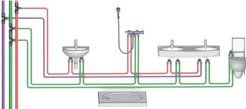
Diese Art der Ringleitungsinstallation eignet sich für Stockwerksinstallationen ohne vorgeschaltete Wasserzähler. Dabei wird die Rohrleitung mittels Doppelanschlüssen von einer Entnahmestelle unmittelbar zur nächsten geführt. Vom letzten Kaltwasserverbraucher führt die Leitung dann wieder zurück zum Stockwerksanschlusspunkt. Das Warmwasserrohr wird vom letzten Verbraucher als Zirkulationsleitung zurück zum Stockwerksanschlusspunkt geführt.
