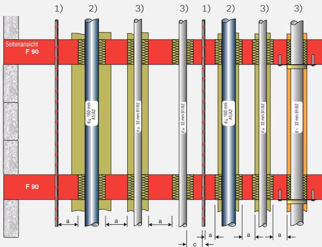
Alle Abstände a gelten bei gedämmten Rohrleitungen 50 mm.
