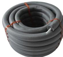
3. Wavin Mehrschicht-Verbundrohr ist im Ringbund mit **26 mm** Dämmung (Wärmeleitfähigkeit = 0,040 W/m·K) lieferbar. Dieses System entspricht der erforderlichen Dämmstoffstärke für Leitungen bis 22 mm.
