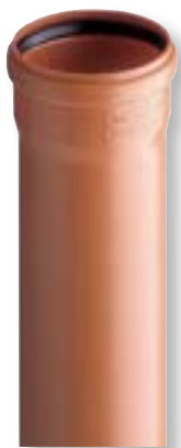
KG PVC csatornacső SN 4 SDR 41; MSZ EN 1401-1 szerint gyártva
