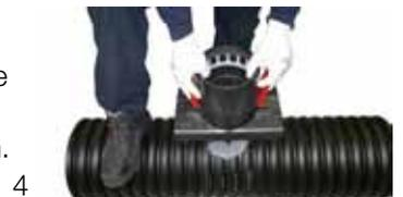
5. Pressez les deux poignées de montage simultanément et uniformément jusqu'au verrouillage. Par l'enfoncement des poignées, le joint est comprimé vers le haut et pressé contre la paroi du tuyau d'égout.
