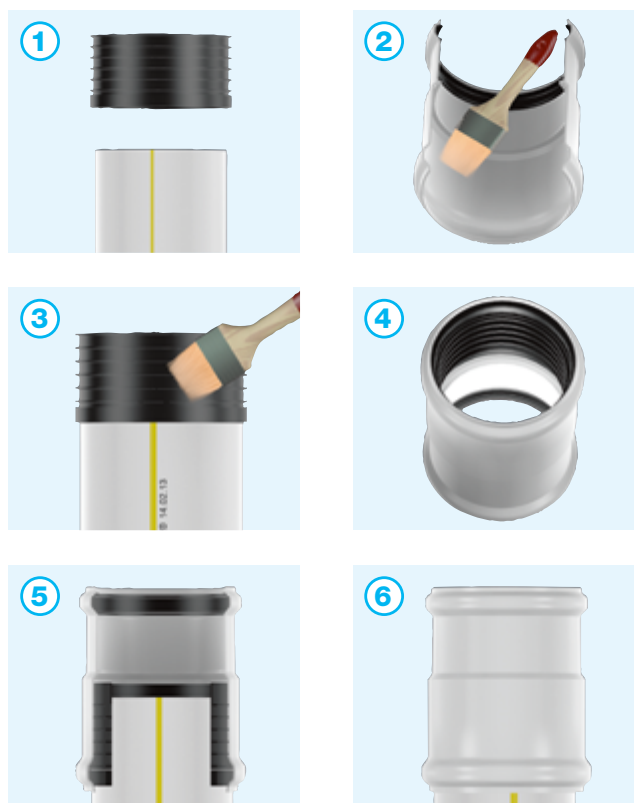
27. ábra: A hőtágulás-kiegyenlítő idom beszerelése
