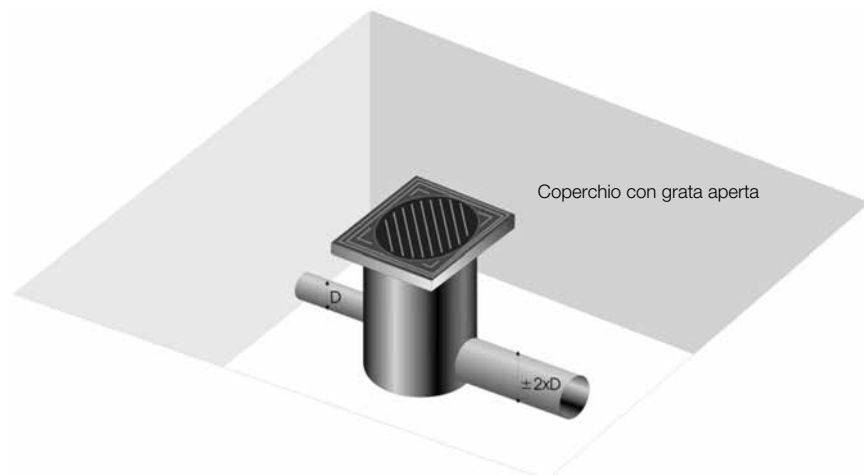
Figura 31. Livello del tubo di scarico.
