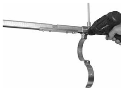
Figura 71. Fissare il bracciale al binario, agganciare la parte anteriore e stringere la vite.
