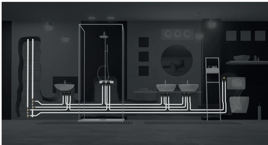
Fig. 44: Installazione ad anello.
