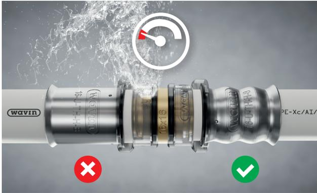
**Fig. 8:** La funzione Leak Free garantisce che le giunzioni erroneamente non pressate vengano individuate durante i test di pressione.
