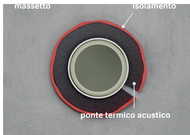
**Fig. 41:** Trasmissione del rumore strutturale causato da un isolamento non conforme.
