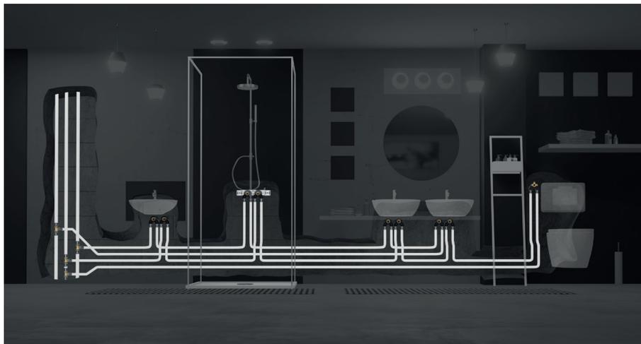
**Fig. 45:** Installazione ad anello con linea di ricircolo.
