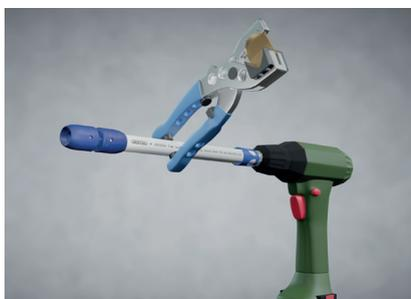
**Fig. 23:** Calibratura della tubazione.
