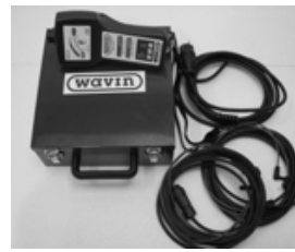
Universeel elektrolasapparaat (diameter 40 - 315mm)
