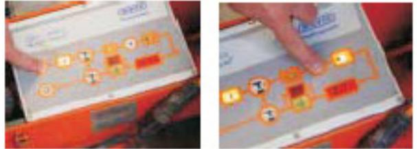
9. Contrôler les indicateurs de soudage pendant et après le travail. Le soudage est terminé quand l'appareil à souder l'indique. Les manchons électrosoudables sont eux aussi équipés d'indicateurs.
