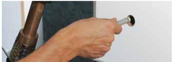
Rimuovere contemporaneamente i componenti dal termoelemento ed eseguire l'accoppiamento senza effettuare movimenti rotatori.
