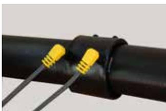
12. Durante e al termine del processo di fusione controllare gli eventuali messaggi della macchina saldamanicotti.
