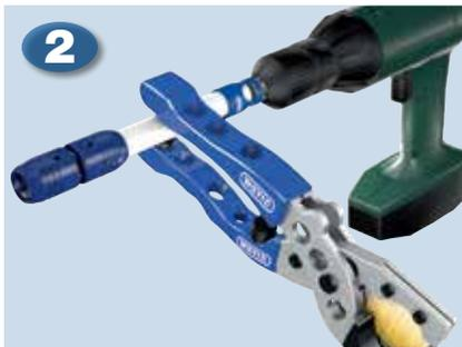
SmartFIX: Se un'estremità del tubo è già connessa ad un raccordo, prima della svasatura con avvitatore assicurarsi che il tubo sia saldamente bloccato! **Evitare che in fase di svasatura il tubo ruoti nel raccordo!**
