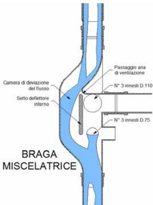
**Vantaggi:** in considerazione delle caratteristiche descritte in precedenza, la braga miscelatrice consente di ottenere numerosi vantaggi.
