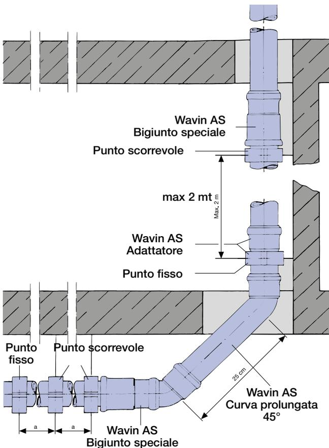
Tutti i tratti di tubazioni facenti parti del sistema devono essere fissati con bracciali aventi un interasse tale da evitarne lo sfilamento in qualsiasi condizione d'esercizio. In caso di raccordi particolari, ad esempio manicotti scorrevoli, il punto fisso va realizzato in prossimità dello stesso e alle tubazioni ad esso collegate (massimo 3 mt) si installeranno un bracciale a punto fisso ed un bracciale scorrevole.
