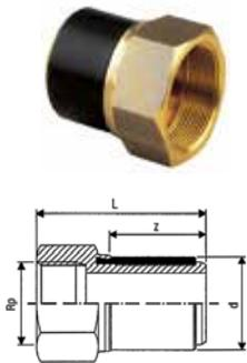
**Nipplo femmina per raccordi elettrosaldabili (Gomiti - Tee - Riduzioni) Monoline PE100**
