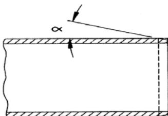
Il tratto da inserire nel bicchiere va pulito da eventuali presenze di polvere, sabbia o tracce di calcestruzzo e lubrificato con l'apposito scivolante. Sono assolutamente da escludere nell'impiego olii o grassi minerali. Ad inserimento avvenuto il codolo va sfilato di un centimetro.
