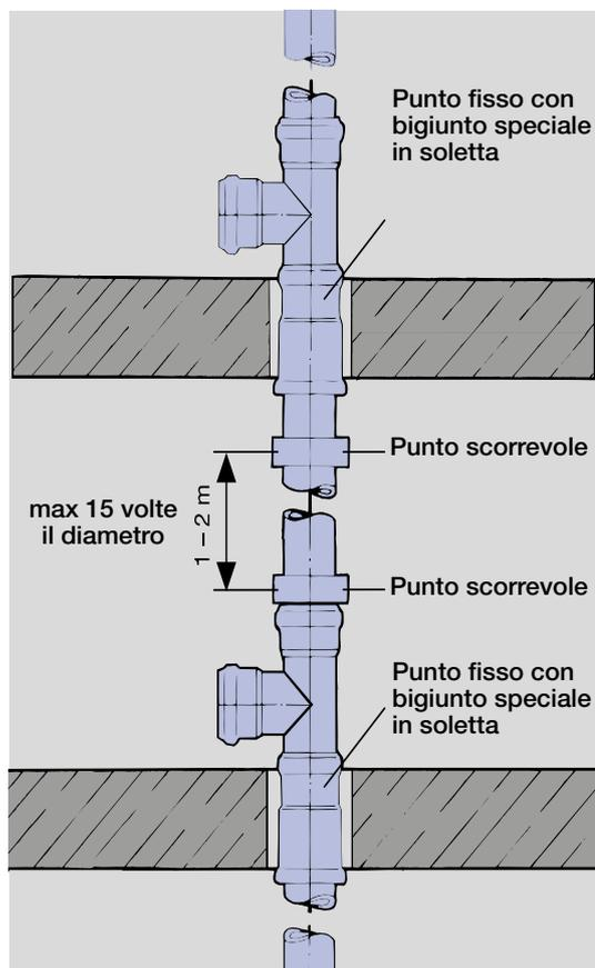
Nel caso di edifici con altezza superiore a 3 piani e colonne di scarico in attraversamento alle solette, si raccomanda di installare, in prossimità del piede di colonna, adattatori con bracciale a punto fisso (con funzione di punto di appoggio) e rispettare la distanza di max. 2 mt per il posizionamento del bracciale a punto scorrevole. (vedi fig. sotto)
