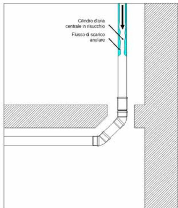
Il pistone idraulico scendendo lungo la colonna di scarico, diminuisce la zona di pressione positiva ed aumenta la zona di depressione o risucchio. Pertanto, in una colonna di scarico, si genera ad ogni utilizzo una variazione continua della pressione dell'aria interna. Forti variazioni di pressione possono provocare variazioni del livello della guardia idraulica dei sifoni allacciati alla colonna, tale fenomeno è chiamato "Sifonaggio".
