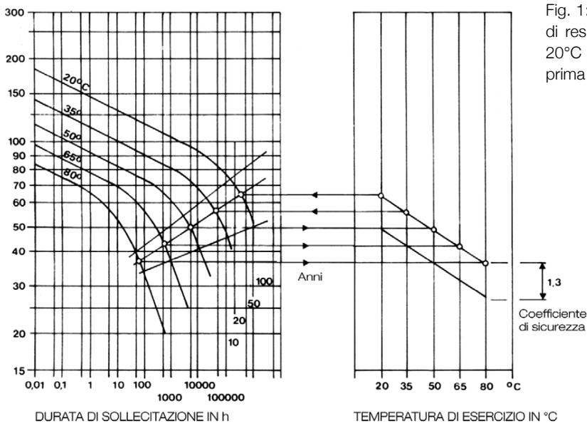
Fig. 1: estrapolazione grafica della curva di resistenza allo scorrimento interno a 20°C per un periodo di 50 per materia prima PE-HD.
