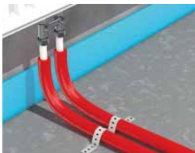
1. Collegamento diretto dei tubi Tigris MP mediante adattatori in ottone (solitamente a corredo delle valvole).
