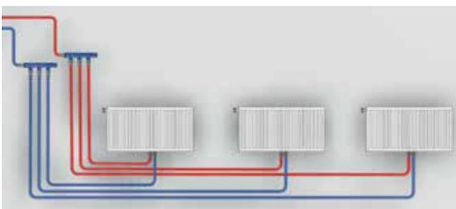
I terminali sono dimensionati in base alla ripartizione del carico termico nei diversi ambienti e la distribuzione dell'acqua calda avviene indipendentemente per ciascun radiatore.
