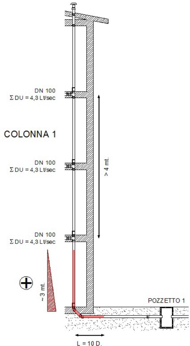
I risultati, in termini di diametri nominali delle tubazioni, sono evidenziati nello schema a lato (Fase 3).
