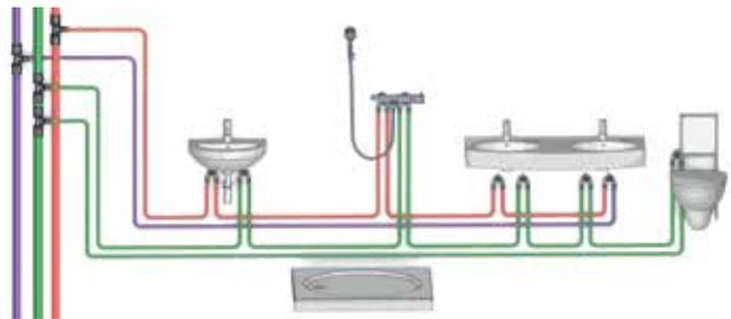
*Esempio 4: Installazione ad anello con impianto di ricircolo.*
