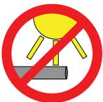
Si raccomanda di proteggere i tubi multistrato Wavin dai raggi UV e dai raggi solari diretti e intensi. Questa precauzione riguarda sia i tubi stoccati che le porzioni di impianto già installate. Lo stoccaggio all'aperto non è, pertanto, consigliabile. Occorre adottare misure idonee per proteggere gli impianti o le porzioni di impianti installati contro l'azione dei raggi UV.
