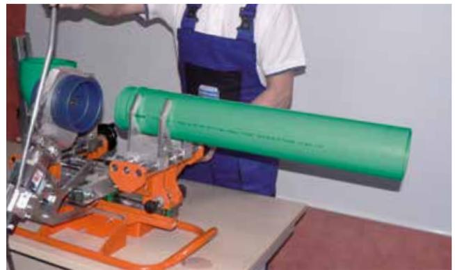
Rimozione dei componenti dal termoelemento
