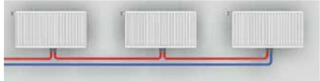
Gli impianti monotubo sono realizzati mediante una distribuzione periferica della superficie da scaldare i cui radiatori sono posti in serie.
