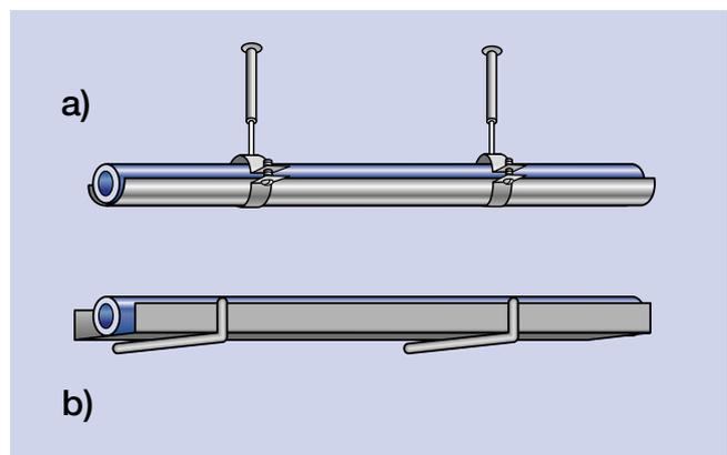
La compensazione della dilatazione viene solitamente eseguita tramite bracci flettenti, omega o anelli di compensazione, la compensazione va eseguita su tutte le tratte sia perpendicolari che parallele al soffitto. Nell'opzione a) il tubo viene staffato insieme alla relativa canalina, mentre nell'opzione b) il tubo viene posato libero sulla canalina.
