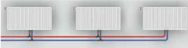
Gli impianti a due tubi ottimizzano l'impiego di tubazioni, senza precludere la possibilità di regolare il singolo radiatore; consiste nel servire in serie e in parallelo con due tubi i diversi radiatori, che ricevono il fluido dal tubo di mandata e lo scaricano su quello di ritorno.
