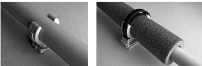
È consentito l'uso di morsetti in plastica per il fissaggio delle tubazioni. Per i tubi isolati si raccomanda di fissare il morsetto sopra lo strato isolante. È consentito l'uso di canaline di supporto per la posa libera delle tubazioni
