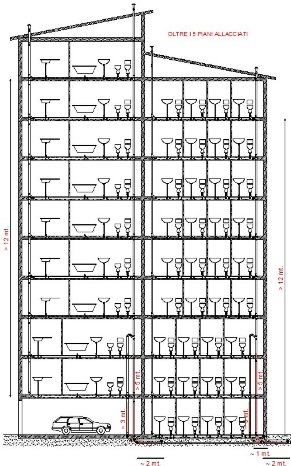
Quando le diramazioni di scarico hanno una lunghezza superiore ai 10 mt, oppure quando si prevede un'elevata contemporaneità di scarico (con forte pericolo di autosifonaggio), è consigliabile modificare gli schemi precedenti con l'inserimento di un collegamento intermedio di ventilazione.
