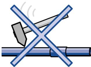
I vari componenti del sistema devono essere protetti dai danni che si possono verificare durante il trasporto e l'installazione.
