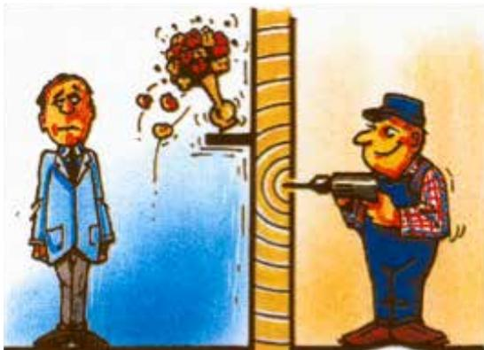
Trasmissione diretta (attraverso la struttura)
