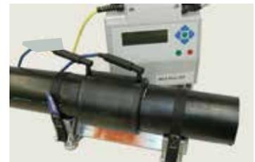
⦿ (K) La rimozione dell'allineatore deve essere effettuata al termine del tempo di raffreddamento indicato sul raccordo. In ogni caso, il giunto saldato non deve essere movimentato né sottoposto a nessun tipo di sollecitazioni esterne e deve essere protetto da condizioni atmosferiche avverse, fino al raggiungimento del completo raffreddamento (temperatura nella zona esterna di saldatura uguale a quella del materiale base adiacente).
