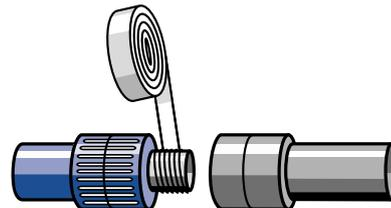
I raccordi filettati devono essere utilizzati per le giunzioni di tipo a vite. Le filettature dovranno essere sigillate con un nastro in PTFE speciale.
