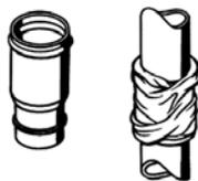
Il manicotto di dilatazione viene fornito con un tappo di protezione per salvaguardare la guarnizione, che deve essere protetta anche in fase di montaggio, onde evitare che cemento, gesso o altro s'introduca tra la guarnizione ed il tubo.
