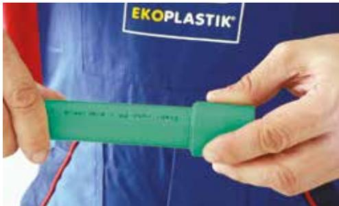
7- Entrambi i componenti devono essere riscaldati in contemporanea per il tempo riportato nella Tabella 1 della pagina seguente, in base al diametro selezionato. **Il tempo di riscaldamento si calcola dal momento in cui sia il tubo che il raccordo sono completamente inseriti nelle rispettive matrici.**
