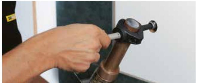
Inserire la matrice riparafori all'interno del foro praticato sul tubo e contemporaneamente inserire anche il tappo riparafori nella rispettiva matrice, senza eseguire movimenti rotatori. Scaldare i componenti per 5 secondi.
