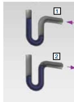
⦿ Sifonaggio per aspirazione: l'acqua nel sifone viene risucchiata all'interno del sistema di scarico a causa di una pressione negativa.
