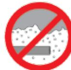
Evitare che i sistemi Wavin entrino in contatto con solventi o materiali da costruzione a base di solventi (come vernici, spray, schiume espansive, collanti).
