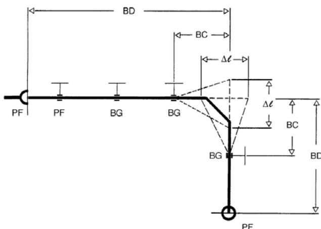
Con il montaggio di appositi punti fissi (PF), l'allungamento ( $\Delta l$ ) delle condotte in PE può essere diretto verso i bracci di una curva, che compenseranno l'effetto della dilatazione.
