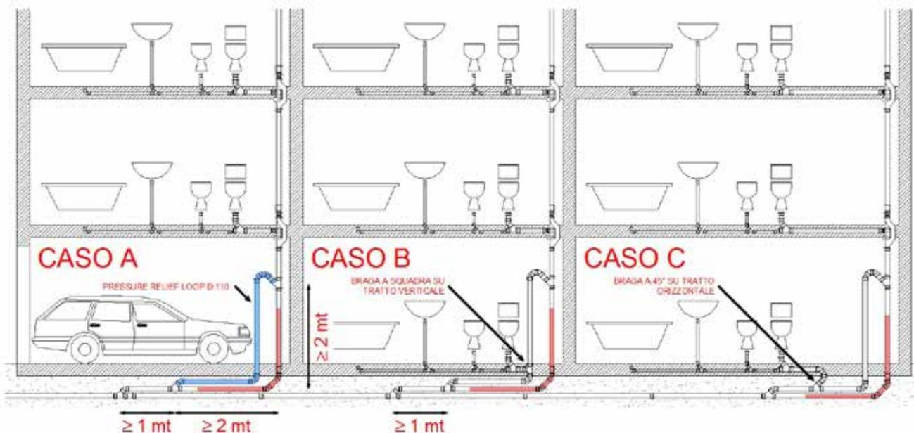
La distanza massima ammissibile tra due braghe miscelatrici è pari a 6 mt. Per distanze superiori è necessario prevedere una deviazione di colonna realizzata tramite quattro curve a 45° ed un tratto intermedio pari a 2 diametri (circa 20 cm.). In questa maniera
