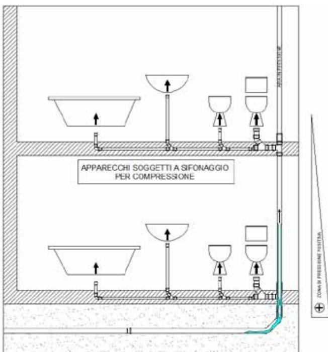
Quando l'acqua raggiunge il piede di colonna si ha il passaggio da flusso anulare a flusso turbolento, l'acqua torna a riempire completamente la sezione del tubo che determina un rimbalzo verso l'alto del flusso d'aria centrale trascinato dall'acqua. La zona di depressione alle spalle del flusso di scarico si trasforma in una zona di pressione positiva, creando l'onda di rimbalzo che può provocare problemi di sifonaggio per compressione negli apparecchi collegati nelle immediate vicinanze.
