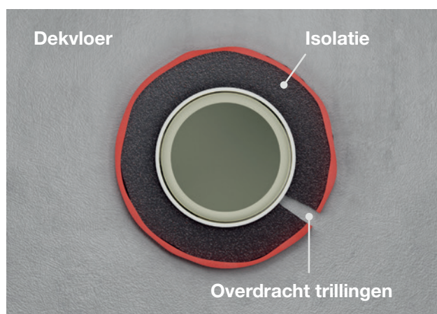
Fig 41: Overdracht mechanische trillingen via beschadigde isolatie.
