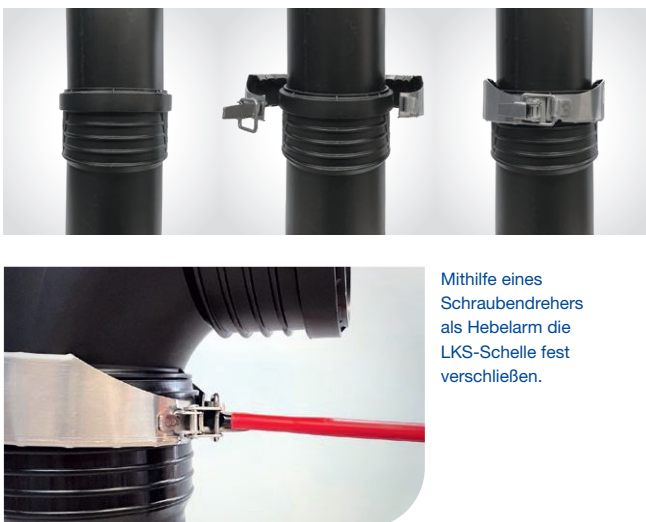
Abb. 48: Montageschritte Wavin LKS-Schelle
