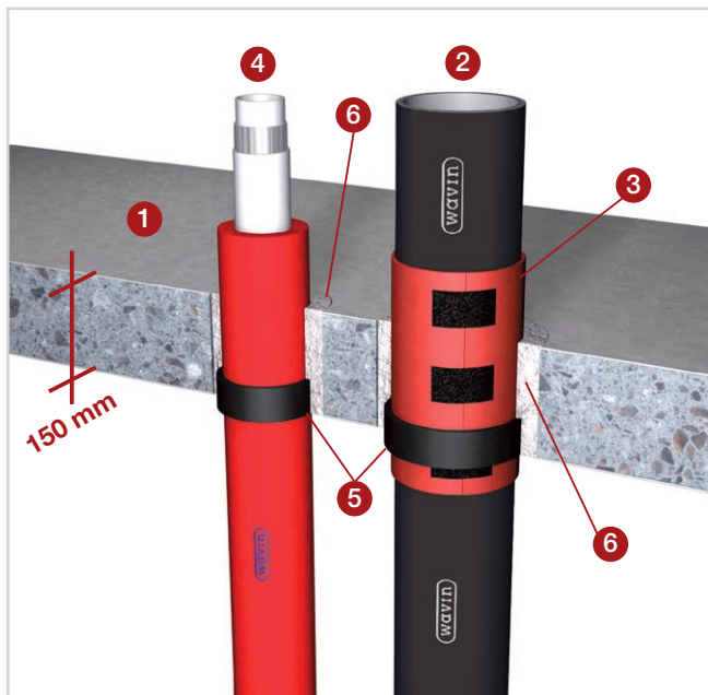
Bild 1: Gerade Rohrleitung durch Decke.
