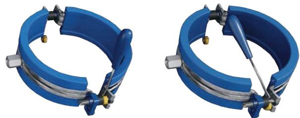
Wechsel von Gleitpunkt zum Fixpunkt: Abstandshalter werden entfernt.
