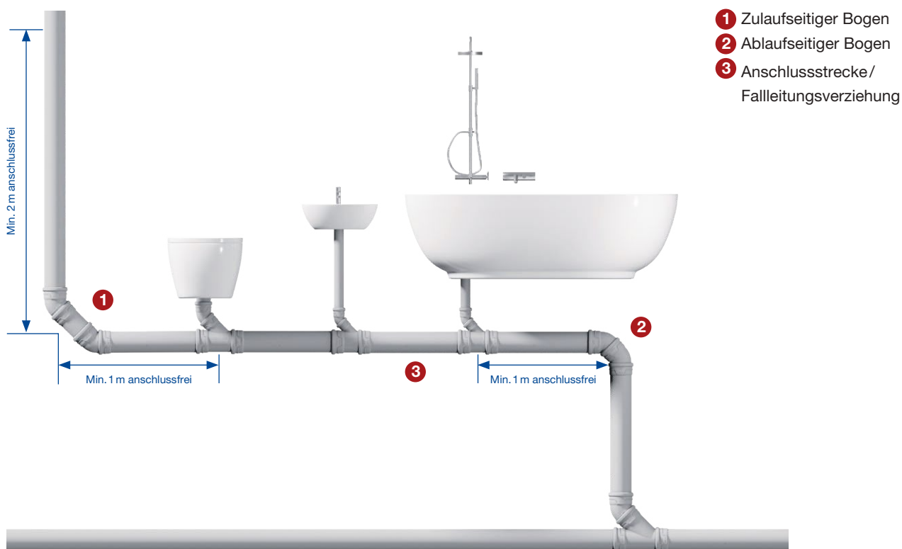
Abb. 8: Fallleitungsverziehung > 2m und anschlussfreie Leitungsbereiche
