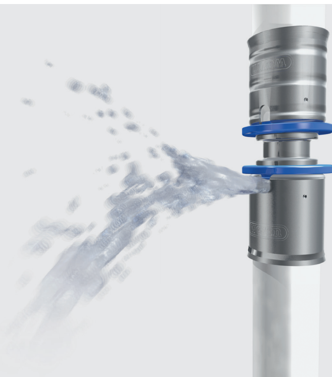
8. ábra: Biztonságot nyújtó, rafinált megoldás: a nyomáspróbánál a szivárgási funkció a le nem préselt kötéseket láthatóvá teszi
