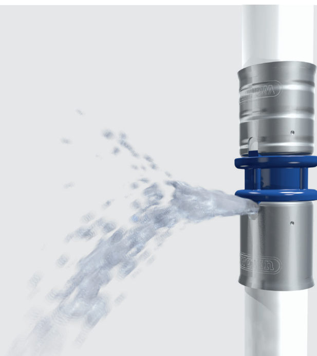
5. ábra: Biztonságot nyújtó, rafinált megoldás: a nyomáspróbánál a szivárgási funkció a le nem préselt kötéseket láthatóvá teszi
