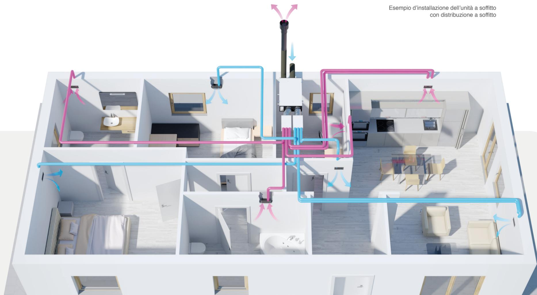
Esempio d'installazione dell'unità a soffitto con distribuzione a soffitto
