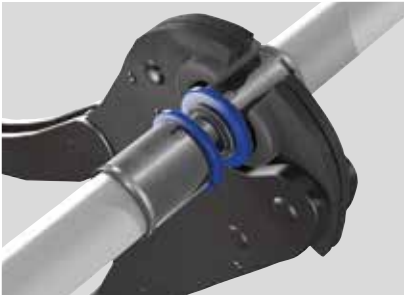
Fig. 21: Placering av pressbackar på beslaget med Tigris K1.
