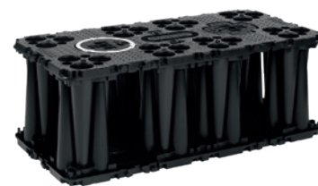
Extra sterke opbouw Twee AquaCell units in tegengestelde richting, voor zware verkeerslasten in combinatie met ondiepe installatie
