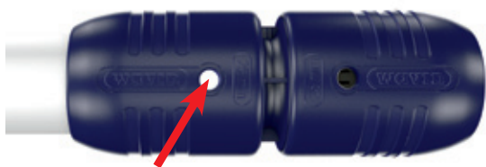
Afb. 8: Via een inspectievenster in de kap kan u controleren of de leiding volledig is ingestoken.
