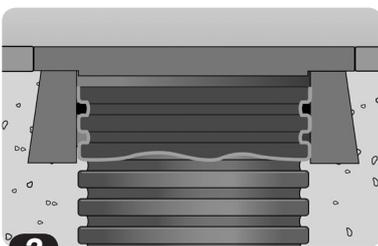
Ved installation af dækseløsning anvendes topafslutningsring eller kegle afhængig af dæksel. Der skal altid benyttes dæksel og teleskopring.
