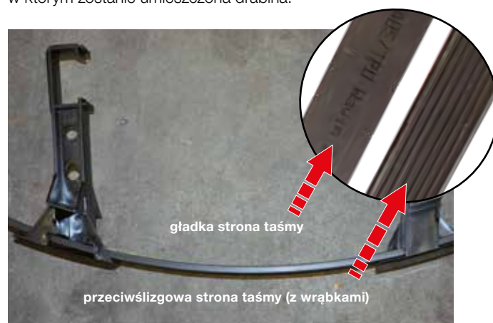
Rys. 4. Szczegół – usytuowanie wsporników drabinki na taśmie. Przeciwślizgowa strona taśmy (od strony rury karbowanej), gładka strona taśmy (od wnętrza studzienki)
