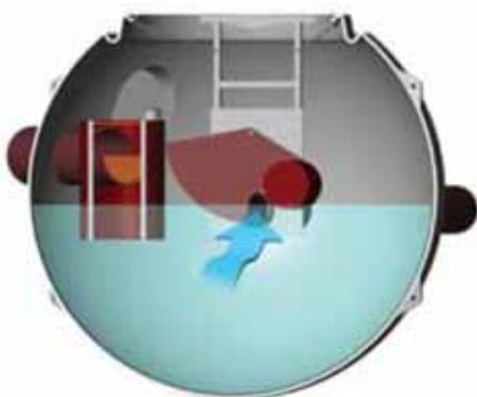
Figur 10. By-pass brønd i normal funktion (nominel ydelse).
