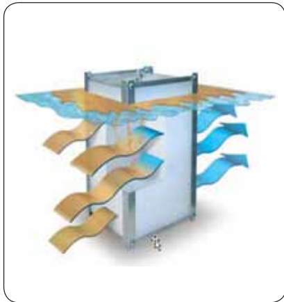
Figur 12. Driftsprincip for koalescensfiltret.
