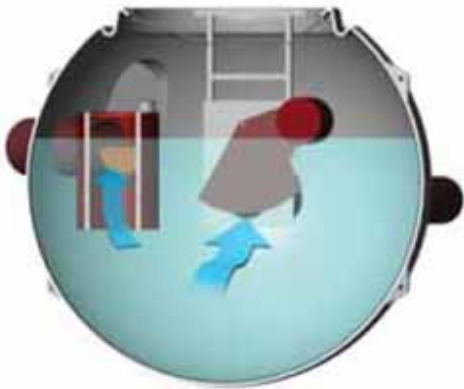
Figur 11. By-pass brønd i omløbsfunktion (maksimal ydelse).
