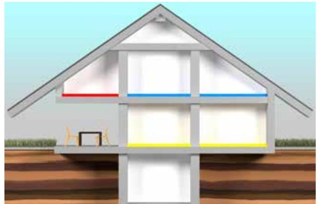
Abb.: Mindestleitwiderstände von Dämmschichten unter FBH
