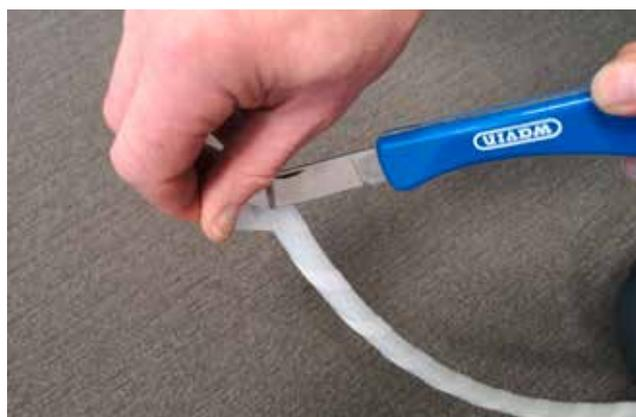
Abb.: Klettband muß vor Aufschieben der Überwurfmutter vom Rohr entfernt werden !
