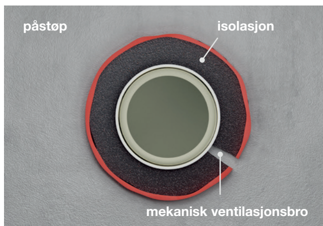
Fig 35: Mekanisk vibrasjonsoverføring gjennom defekt rørisolasjon.
