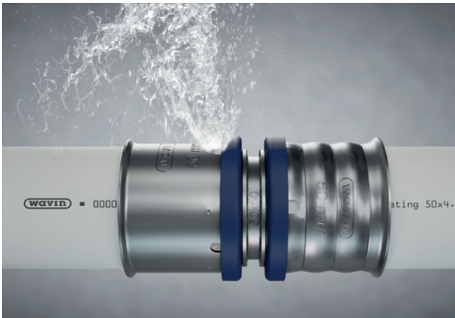
Fig.16: DEFINERT LEKKASJE i trykktesten avslører lekkasje i den upressede armaturen.
