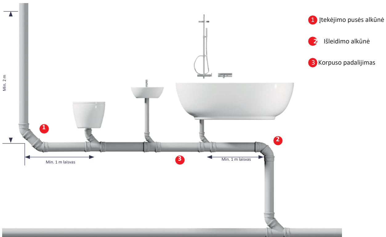
13 pav. Nuotekų vamzdžio poslinkis > 2 m su vamzdžių sekcijomis be sujungimo taškų.
