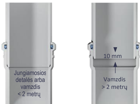
27 pav. 10 mm tarpas šiluminiam plėtimuisi.
