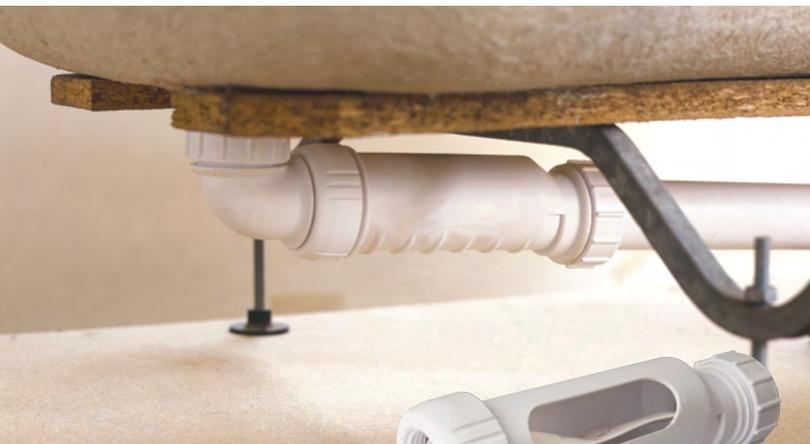
Le siphon à membrane Wavin Hep<sub>v</sub>O est doté d'une membrane spécialement conçue pour assurer une séparation étanche entre l'espace de vie et le système d'évacuation. La membrane s'ouvre sous l'effet de l'eau courante et se referme hermétiquement après le passage de l'eau. **Finies les mauvaises odeurs !**
