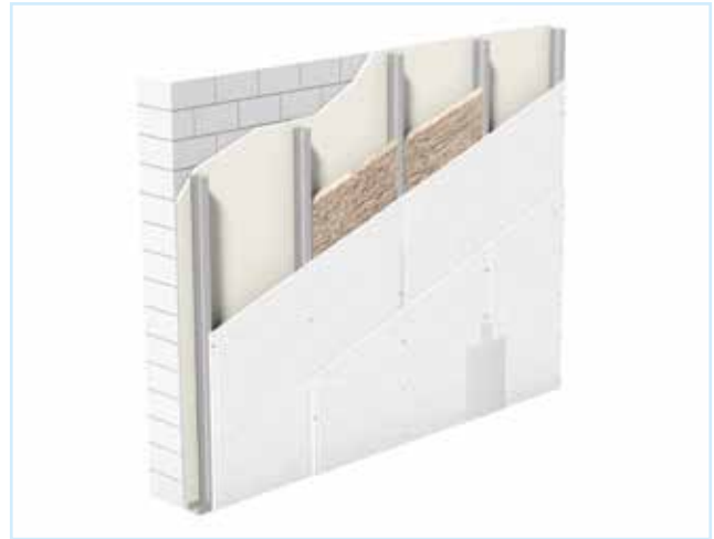
Kuva 24: Peiteseinä massiivisen seinän yhteydessä (lähde: Knauf)
