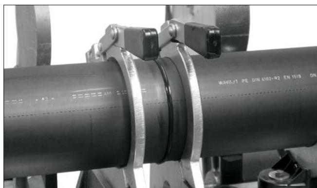
Chladnutí svařeného spoje
