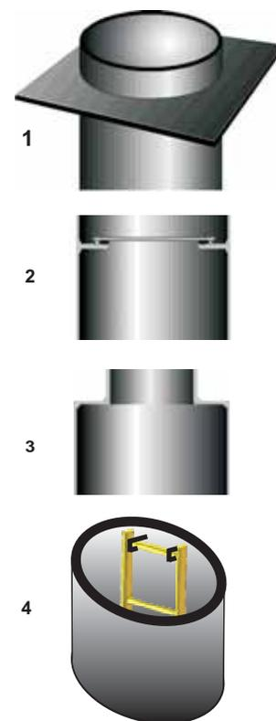
**Description:** Chambre de visite réalisée sur mesures avec un fond profilé et pouvant être équipée de: plateau d'étanchéité ou d'ancrage (fig 1), couvercle intermédiaire étanche aux odeurs (fig 2), trou d'homme réduit (fig 3) ou échelle (fig 4).
