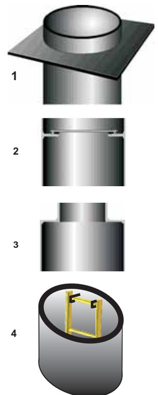
**Omschrijving:** Op maat en volgens opgave profielbodem gemaakte toezichtspuit welke kan uitgerust worden met: waterkering- of verankeringflens (fig 1), reukdicht tussendecksel (fig 2), verkleind mangat (fig 3) of ladder (fig 4). Bijkomende inla(a)t(en) kunnen op elke gewenste hoogte en onder elke gewenste hoek, in functie van de diameter.
