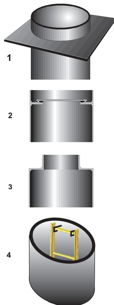
**Omschrijving:** Naar maatopgave gemaakte bezinkput welke kan uitgerust worden met: waterkering- of verankeringflens (fig 1), reukdicht tussendeksel (fig 2), verkleind mangat (fig 3) of ladder (fig 4). Bijkomende inla(a)t(en) kunnen op elke gewenste hoogte en onder elke gewenste hoek, in functie van de diameter.
