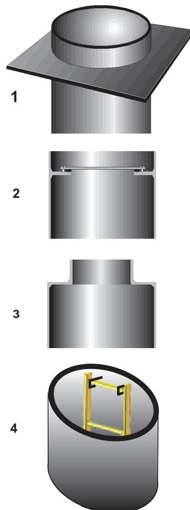
**Description:** Décanteur réalisé sur mesures et pouvant être équipé de: plateau d'étanchéité ou d'ancrage (fig 1), couvercle intermédiaire étanche aux odeurs (fig 2), trou d'homme réduit (fig 3) ou échelle (fig 4).
