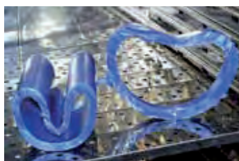
Badanie pamięci kształtu (test dla „Stanu-M”)
