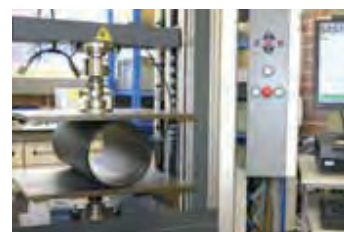
Badanie sztywności obwodowej rury (test dla stanu „I”)
