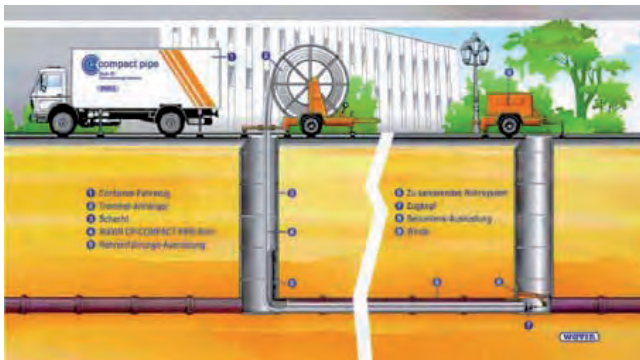
Rysunek 34 Ustawienie sprzętu i organizacja powierzchni instalacyjnej
