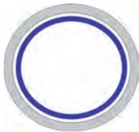
Rysunek 8 Wykładzina we wnętrzu starego rurociągu
