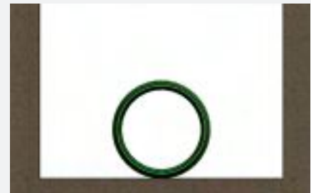
Typ 3: Auflager auf einer vorbereiteten Grabensohle
