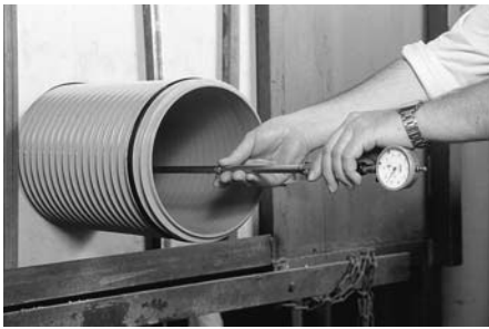
Pav. 17.4. Staigaus apkrovimo bandymu tikrinamas gaminio lankstumas realiomis gamtinėmis sąlygomis
