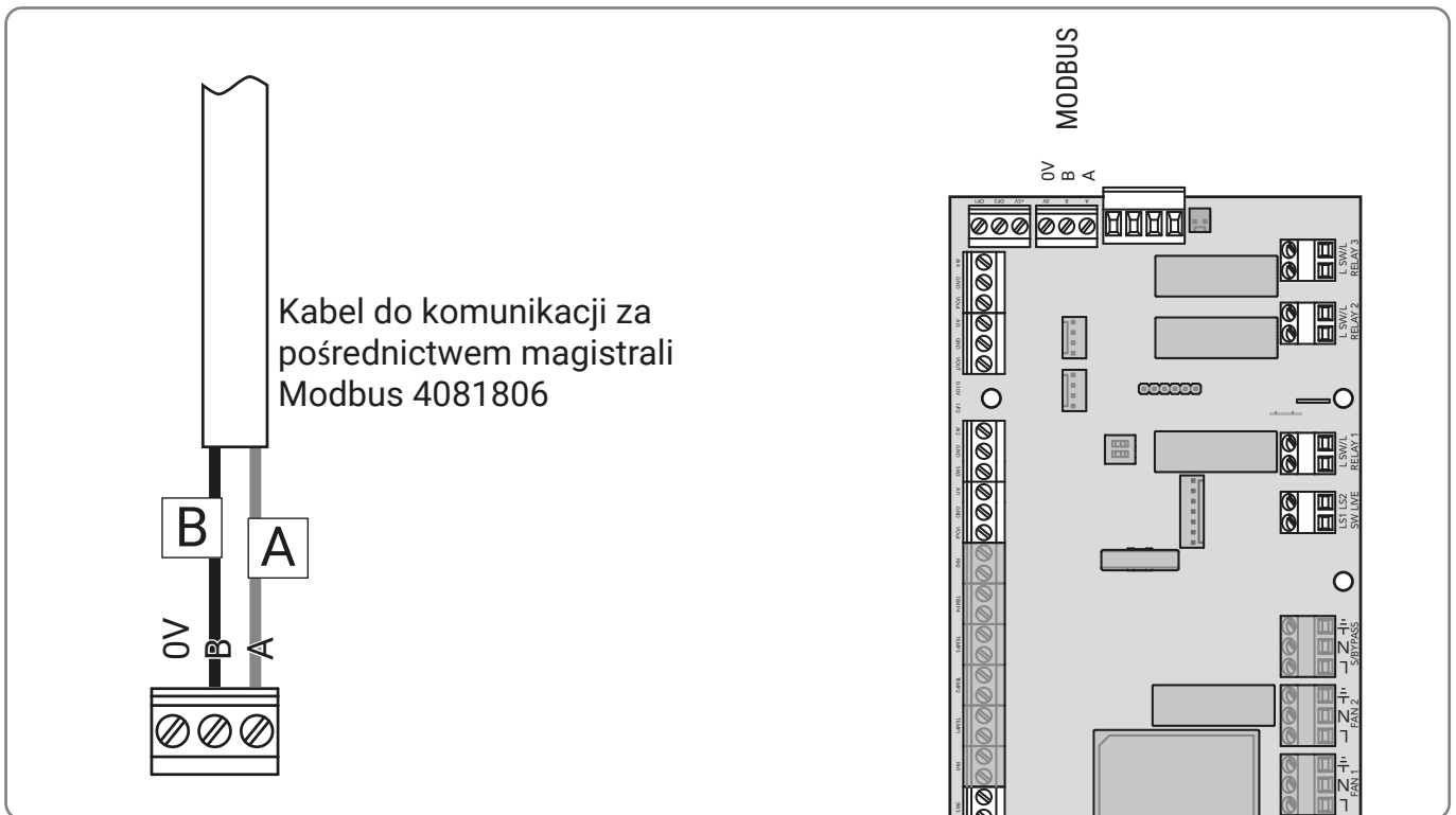
Połączenie z urządzeniem HRU za pośrednictwem magistrali Modbus
