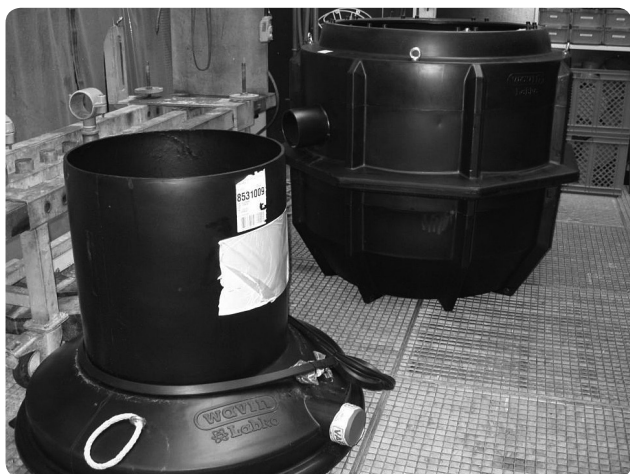
Opføringsrør EuroHUK og udskiller.
