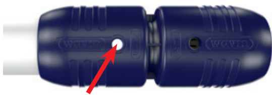
III. 8: Une fenêtre située sur le capuchon permet de contrôler si le tuyau est inséré jusqu'à la butée
