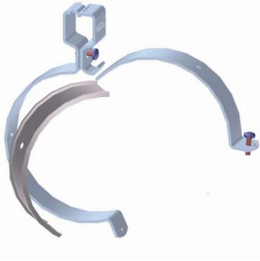
Fig. 1 Schéma collier et demi-coquille métallique
