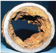
Für Druckrohrleitungen reichen in der Regel mechanische Reinigungen mit Kratzmolchen u.Ä. aus. Wichtig für den Erfolg der Installation ist die Gewährleistung des Mindestquerschnittes. Dafür wird die Rohrleitung nach der Reinigung kalibriert. Die Kamerainspektion, Reinigung und Kalibrierung eines Kanals bzw. einer Altrohrleitung sind ein Muss für die erfolgreiche Installation.
