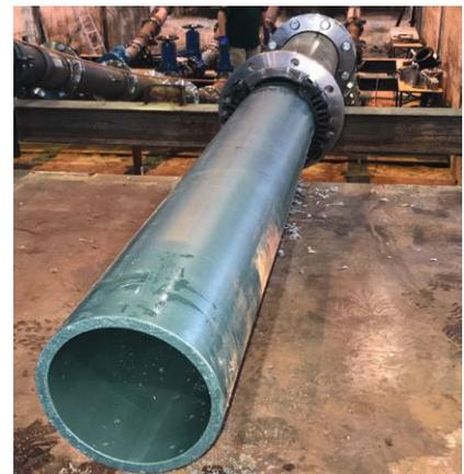
Compact Pipe® Installation, DN 200, SDR 17, PE 100 beim IKT Warentest
