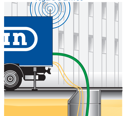
Figure 3 : Conteneur de vapeur avec commande du processus intégrée
