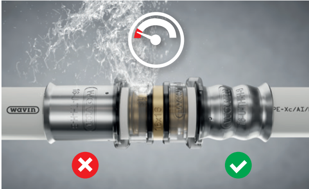
Afb. 8: DEFINED LEAK. Ongeperste fittingen lekken duidelijk zichtbaar tijdens de druktest.
