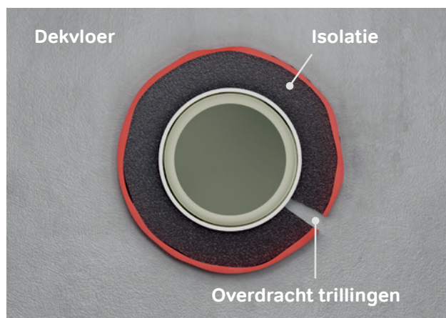
Fig 41: Overdracht mechanische trillingen via de beschadigde isolatie.
