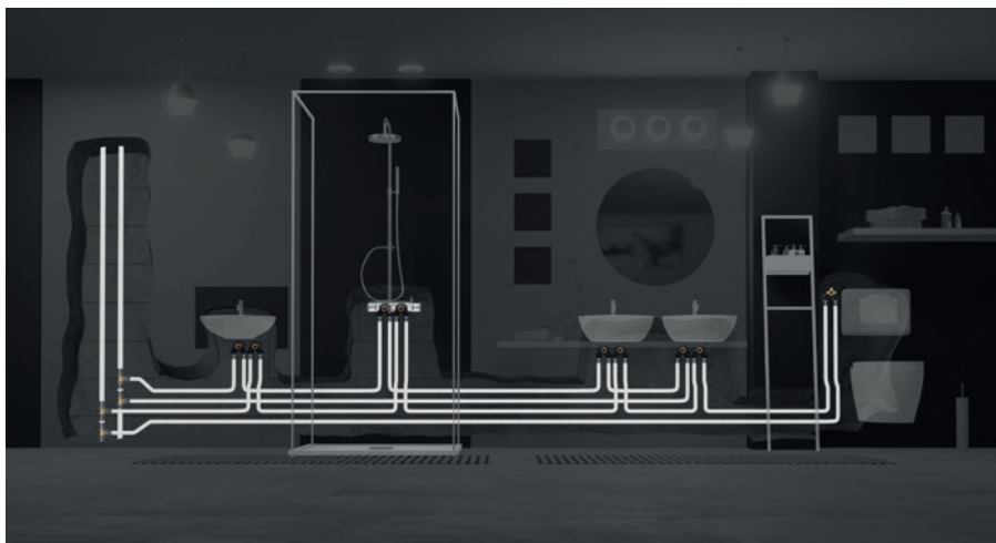
Afb. 44: Circulatieleiding met aansluiting op de retourleiding.
