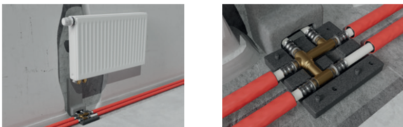
Afb. 48: Radiator aansluiting met een kruisingsvrij T-stuk.
