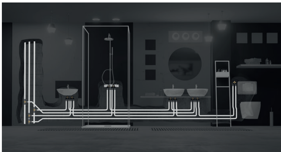
Afb. 45: Circulatieleiding met aansluiting op de retourleiding
