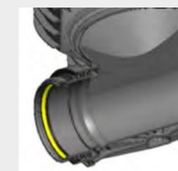
L'ensemble de la gamme de fonds Wavin Tegra 800 est muni de boîtier d'articulation jusqu'au diamètre 315 aux niveaux des emboîtures femelles, permettant une déviation angulaire de + ou -7.5° soit 15° par fond et un accompagnement de pente de 0% à 13%.
