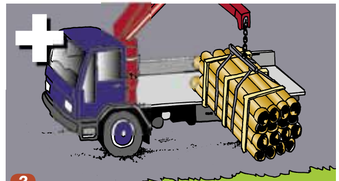
2 Anvend kran og løftestropper af tekstil ved aflæsning af rør i trærammer. Alternativt anvend gaffeltruck.
