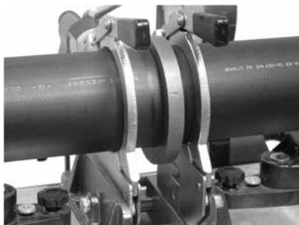
**10. Ridurre la forza quasi a zero, assicurando il contatto con la piastra termica in modo che il calore penetri in entrambe le estremità dei tubi.**
