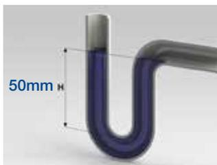
Secondo quanto stabilito dalla normativa UNI EN 12056 la guardia idraulica del sifone "H" non deve essere inferiore a 50 mm per poter assicurare l'efficacia del "tappo idraulico". Tale tappo idraulico deve essere garantito anche nel caso in cui l'apparecchio
