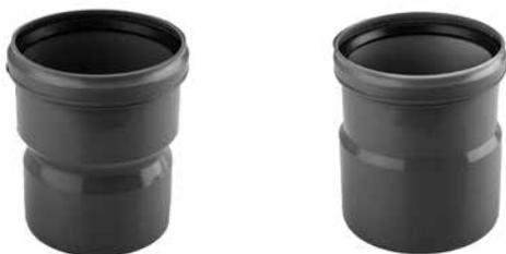
Se la colonna montante è in PVC, è possibile allacciare una diramazione WAVIN ED TECH usando una curva di passaggio in PVC. Il WAVIN ED TECH si innesta nel bicchiere della curva e la curva può essere incollata alla braga in PVC della colonna.
