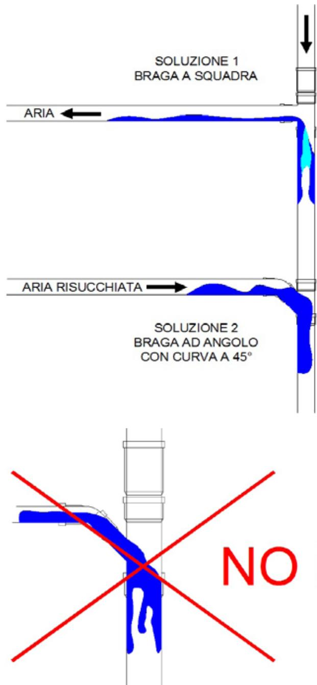
**Deviazioni della colonna di scarico:** in fase progettuale la deviazione della colonna di scarico dovrebbe essere sempre evitata, essendo quest'ultima, per definizione, una tubazione ad andamento prettamente verticale. Tuttavia, in caso di necessità (per evitare parti strutturali del fabbricato, per esigenze architettoniche diverse ai vari piani, per rallentare il flusso di scarico, ecc...), è possibile adottare una o più deviazioni laterali.
