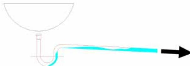
rimozione del tappo idraulico causa la fuoriuscita di aria maleodorante dal sistema di scarico.
