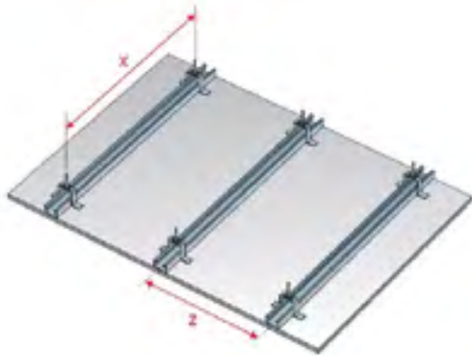
Direktfüggesztővel szerelt álmennyezet CD profilok használatával
