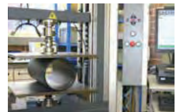
Badanie sztywności obwodowej rury (test dla stanu „I”)
