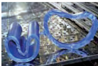
Badanie pamięci kształtu (test dla „Stanu-M”)
