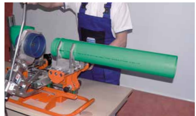
Rimozione dei componenti dal termoelemento
