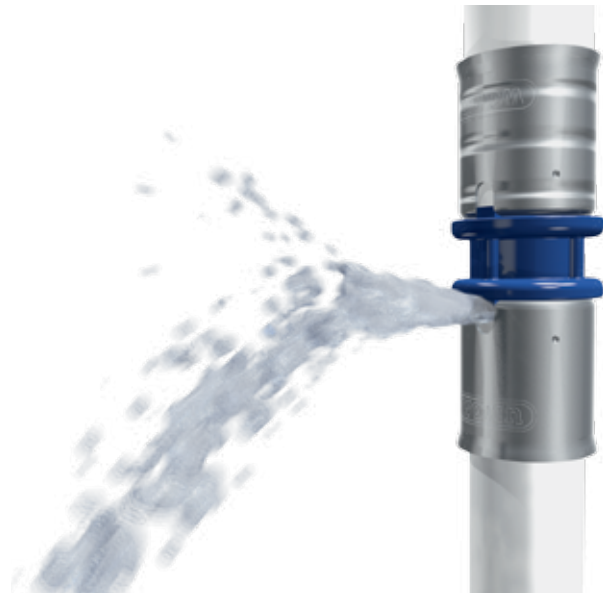
Fig. 4: Sicurezza attraverso soluzioni intelligenti: La funzione Leak Free garantisce che le giunzioni erroneamente non pressate vengano individuate durante i test di pressione.
