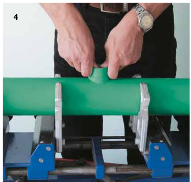
4 Dopo aver tolto il polifusore, il raccordo a sella viene inserito nel foro riscaldato. Tale operazione deve essere effettuata in modo esatto e senza torsioni, sulla superficie esterna riscaldata del tubo. Il raccordo a sella viene premuto sul tubo per 16 secondi. Dopo il tempo di raffreddamento di 10 minuti il raccordo può sostenere carichi. La corrispondente tubazione per la derivazione viene saldata nel raccordo con la solita tecnica per polifusione.
