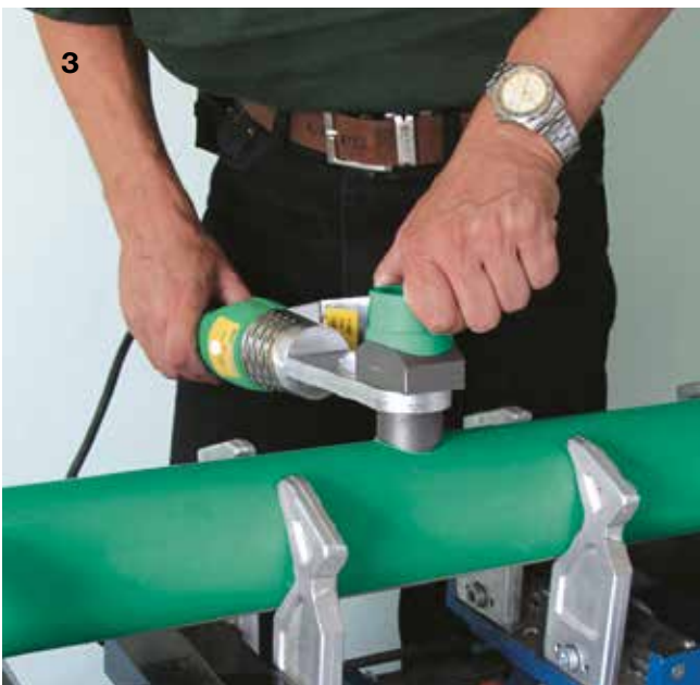
3 Assicurarsi che il polifusore e le matrici a sella abbiano raggiunto la temperatura di esercizio ( 260^{\circ} \pm 10^{\circ} \text{C} ) La parte concava della matrice deve essere inserita nel foro praticato nella tubazione fino al raggiungimento della parete esterna del tubo. Contemporaneamente inserire il raccordo nella parte convessa della matrice. Il tempo di riscaldamento è di 12 secondi per tutti i diametri.
