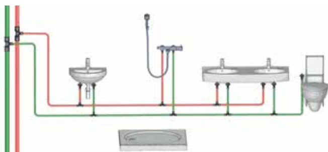
Esempio 1: Sistema di distribuzione tradizionale: installazione con raccordo a T.
