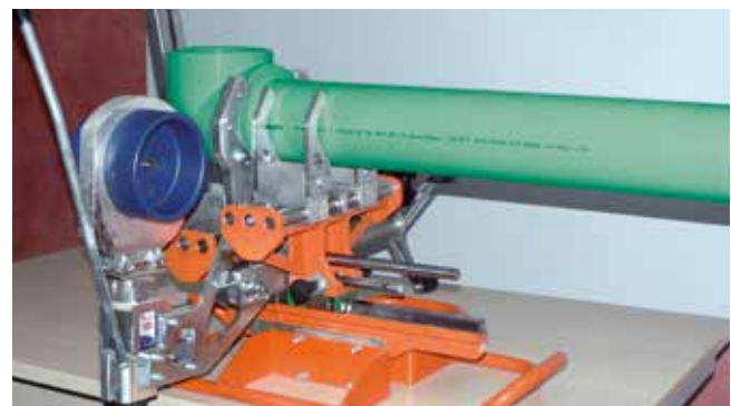
Accoppiamento dei componenti e inizio fase di raffreddamento
