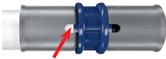
Fig. 2: Attraverso la finestra di controllo della bussola pre-assemblata in acciaio inox si può controllare il corretto inserimento del tubo fino alla battuta.
