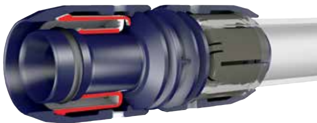
Fig. 9: L'anello interno antisifilamento, garantisce con una doppia azione il bloccaggio del tubo.
