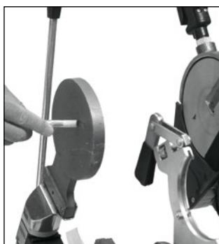
Kontrola teploty svařovacího zrcadla pyrometrem
