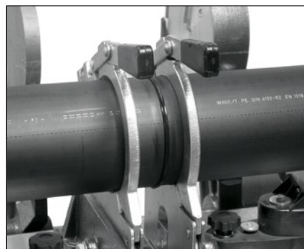
Chladnutí svařeného spoje
