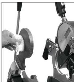
Čištění svařovacího zrcadla – dbejte na to, aby nedošlo k poškození teflonové vrstvy
