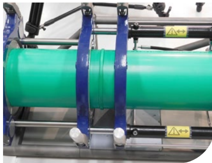
Svaření a chladnutí spoje
