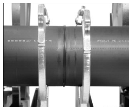
Správně vytvořený svarový spoj na tupo
