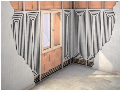
Il sistema a parete WD-10i nasce per la realizzazione di impianti radianti a parete a secco e lo si può installare sia in edifici nuovi che durante lavori di ristrutturazione.
